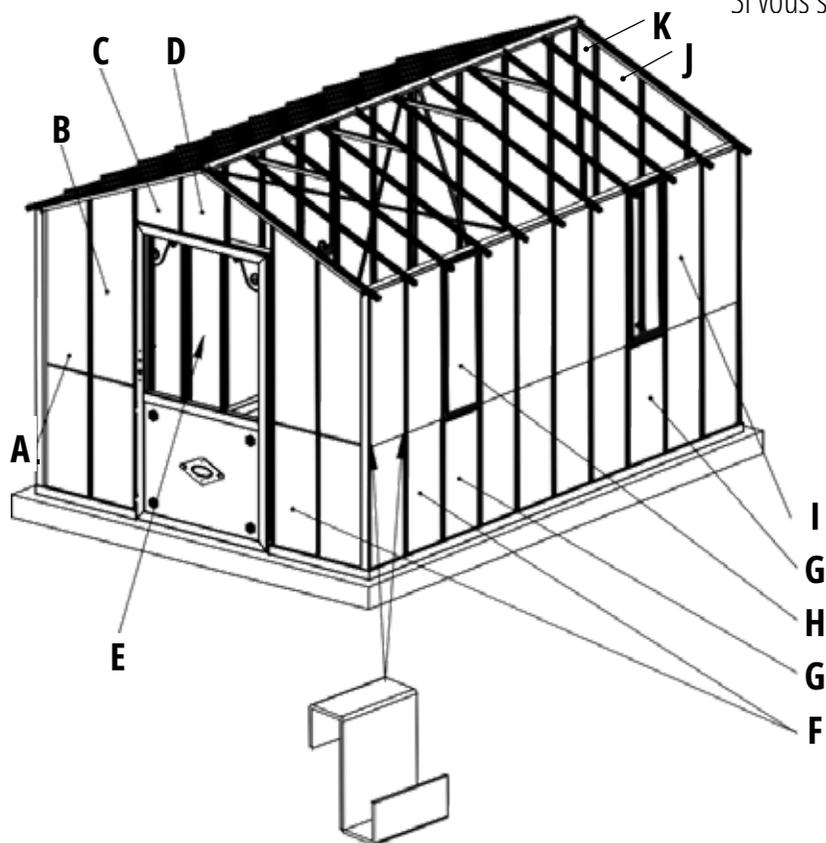
Installation des clips de fixation (25),
