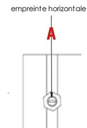
La vis à tête hexagonale (30) se glisse dans le profil et ne peut donc plus sortir du profil une fois le montage effectué.
