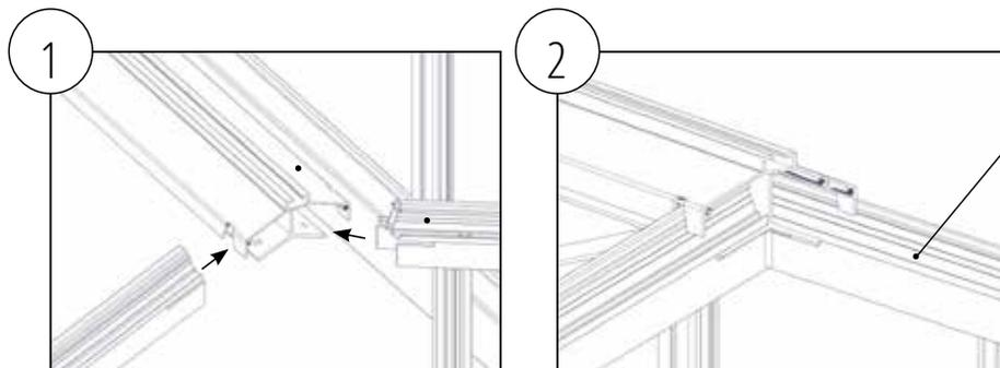
Glissez les battées de toiture dans les fentes respectives de la faitière et vissez les avec les vis (29/30) et écrous (32).
