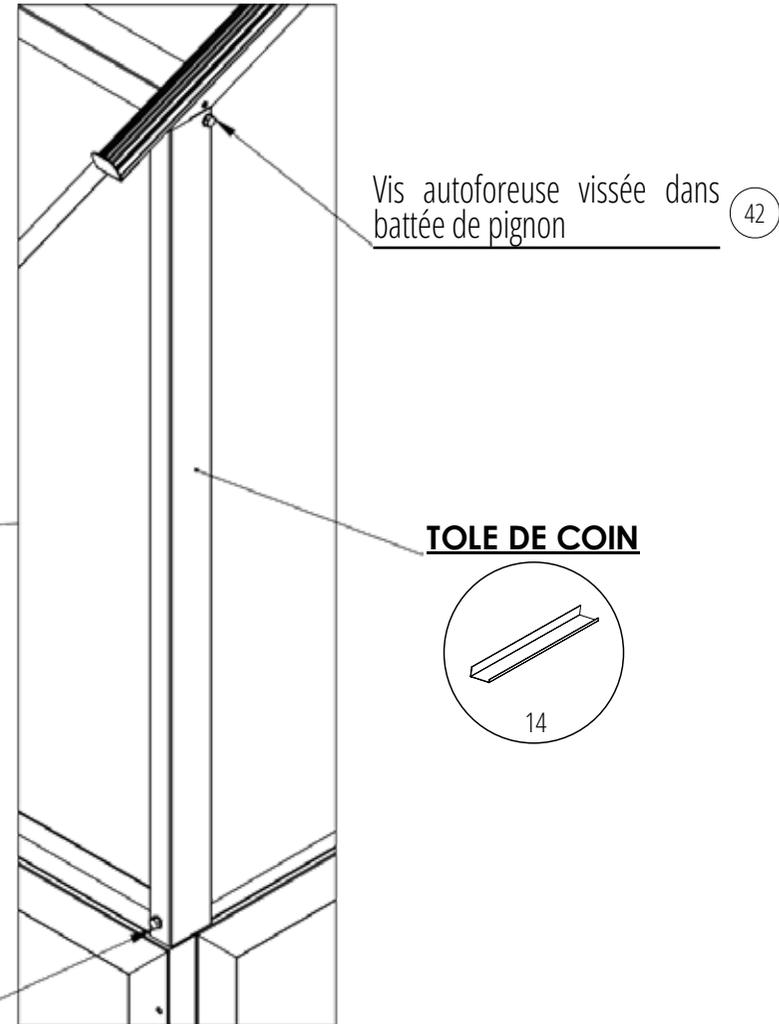
42 Vis autoforeuse vissée dans battée de côté
