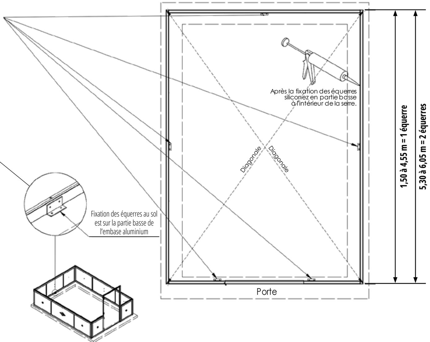
Fixation des équerres au sol est sur la partie basse de l'embase aluminium
