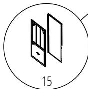
Posez le cadre et fixez le, ainsi que les demi-charnières mâles. La fixation de la partie basse (dans le muret) s'effectue à l'aide des chevilles (40) et des vis (39). La fixation de la partie haute s'effectue à l'aide des vis (32) et des écrous (36).
