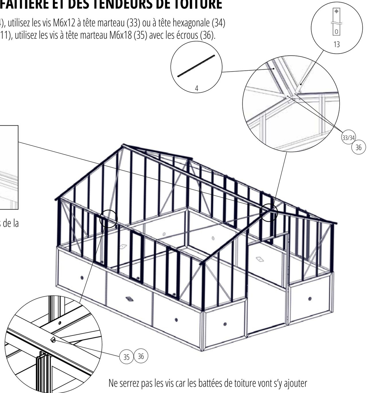
Ne serrez pas les vis car les battées de toiture vont s'y ajouter
