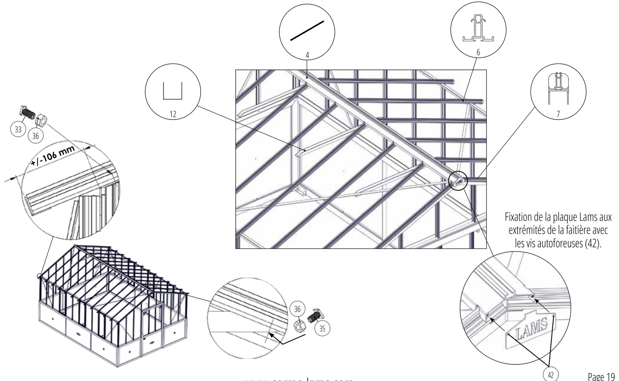
Fixation de la plaque Lams aux extrémités de la faitière avec les vis autoforeuses (42).
