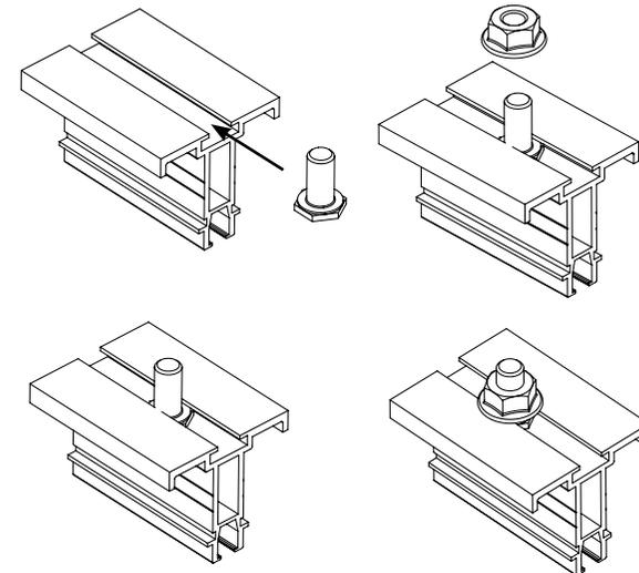
Il existe une fente à l'extrémité de la tête marteau. Le positionnement perpendiculaire au profil de cette fente (schéma **A**) vous assure que la tête de la vis marteau est correctement positionnée.
