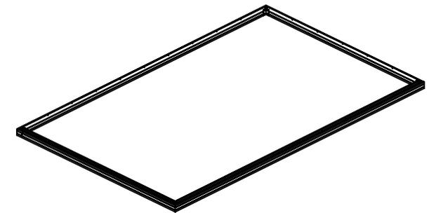
**Fixer la base de manière définitive sur une surface plane et d'équerre une fois votre structure aluminium entièrement montée (hors portes et lucarnes)**
