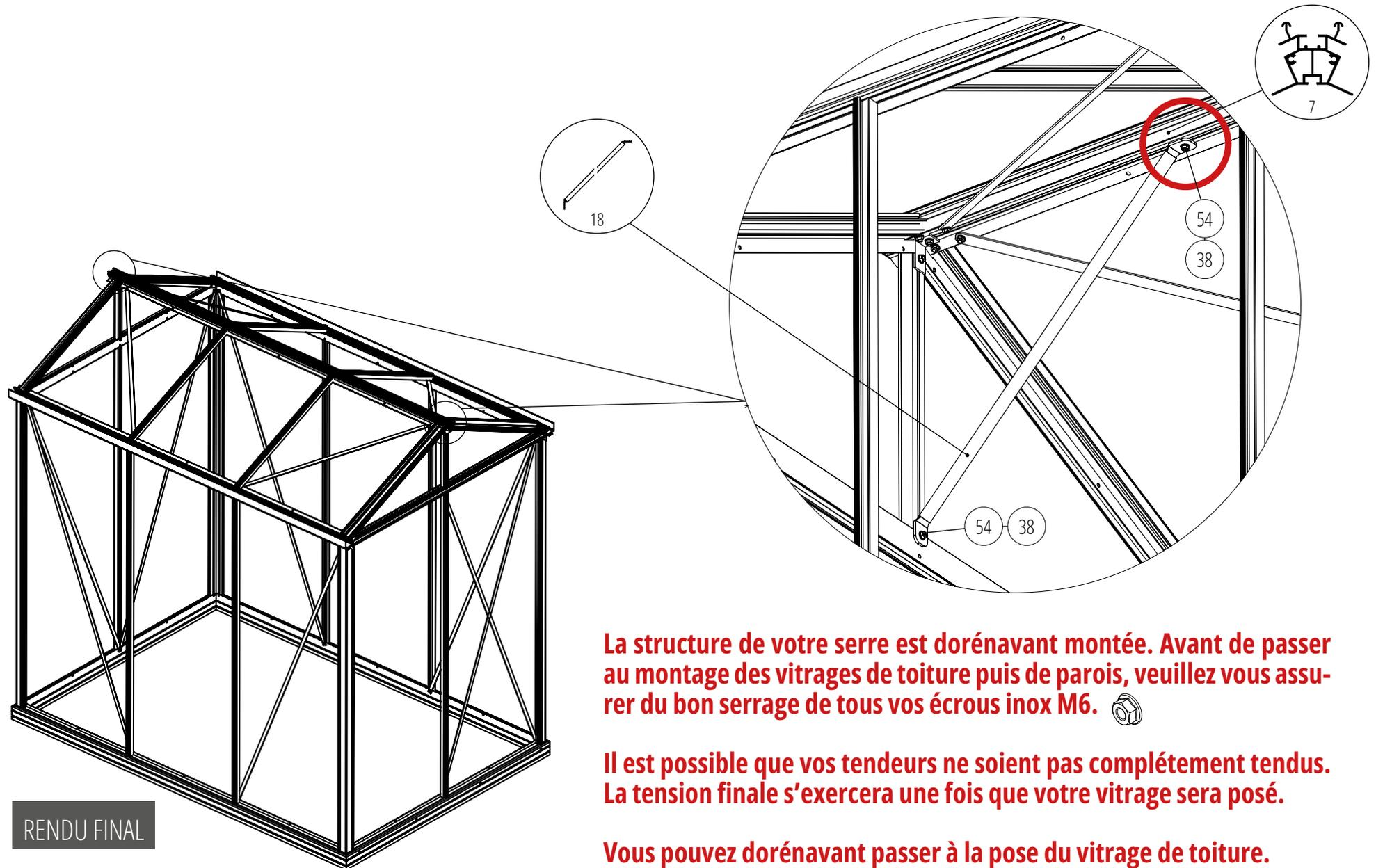
**La structure de votre serre est dorénavant montée. Avant de passer au montage des vitrages de toiture puis de parois, veuillez vous assurer du bon serrage de tous vos écrous inox M6.
