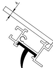
**4** Positionner le joint (58) sur la lucarne de manière que le côté avec la lèvre soit posé sur le verre.
