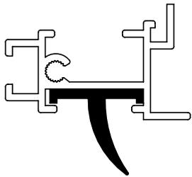
Position du joint (57) sur le rail bas (14)
